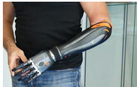
Il est également beaucoup plus facile de créer des prothèses parfaitement ajustées en combinant numérisation et impression 3D. L'équipe R&D de [Chabloz Orthopedie](#) a utilisé un scanner portable de peel 3d pour scanner le membre opposé d'un patient afin de créer une image miroir servant de base de travail. La prothèse ainsi conçue est parfaitement proportionnelle à l'autre membre.
