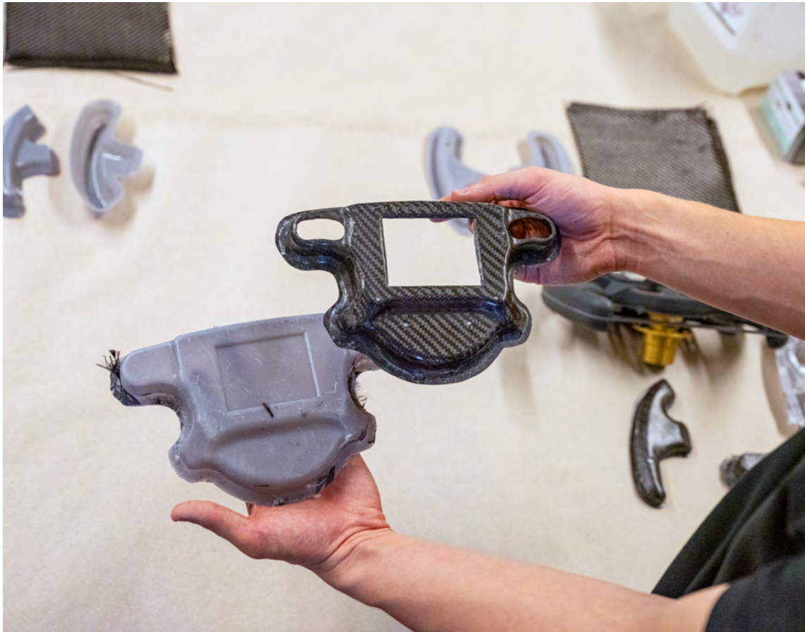
Un moule imprimé en 3D destiné au laminage manuel de pièces en fibre de carbone.
