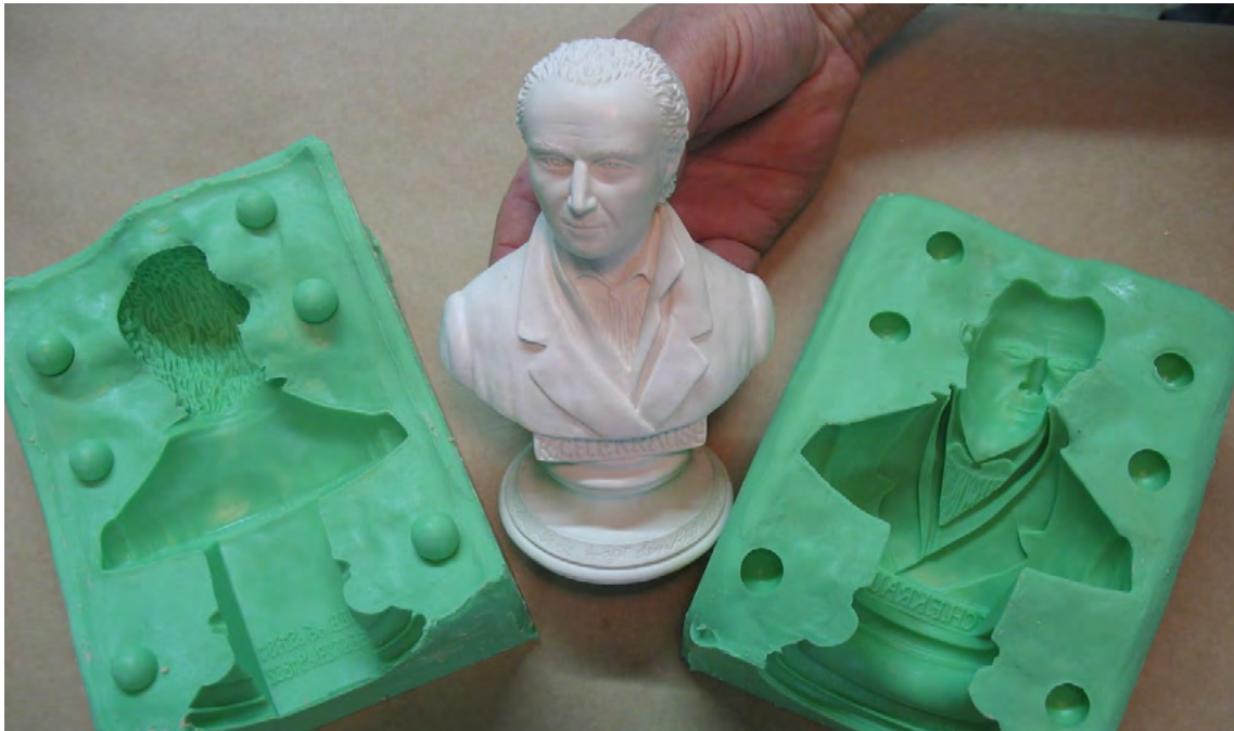
Les moules en silicone en deux pièces peuvent reproduire des masters de tout type (source de l'image)
