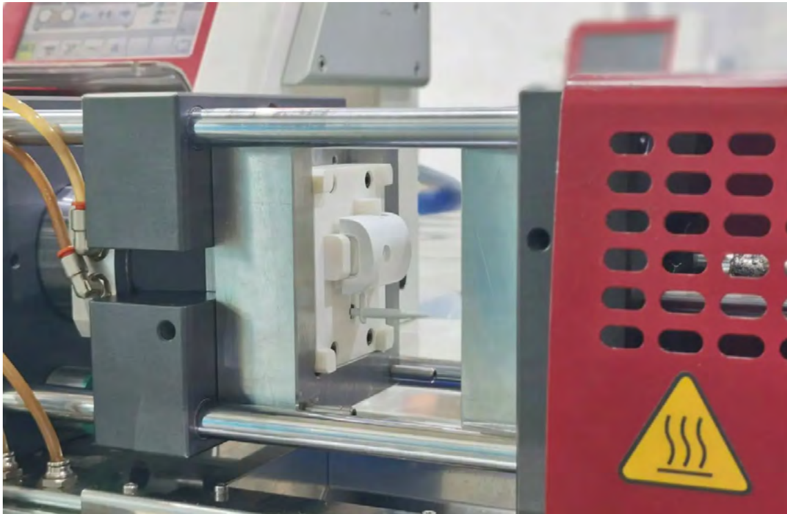
Un moule imprimé en 3D avec Rigid 10K Resin pendant le processus de moulage par injection.
