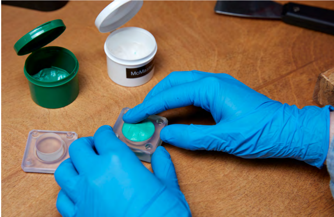
Le composé silicone est placé dans le moule imprimé en 3D.
