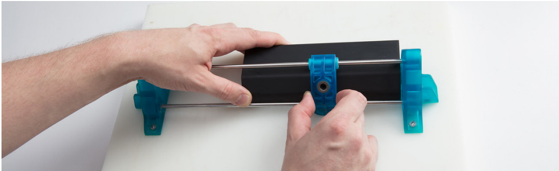
Le gabarit de perçage glisse en douceur sur les rails en acier à l'aide de bagues en Durable Resin pressées dans le guide fait en Tough Resin.
