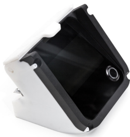
Un gabarit d'assemblage utilisé pour la fabrication de l'imprimante 3D Formlabs Form 2.
