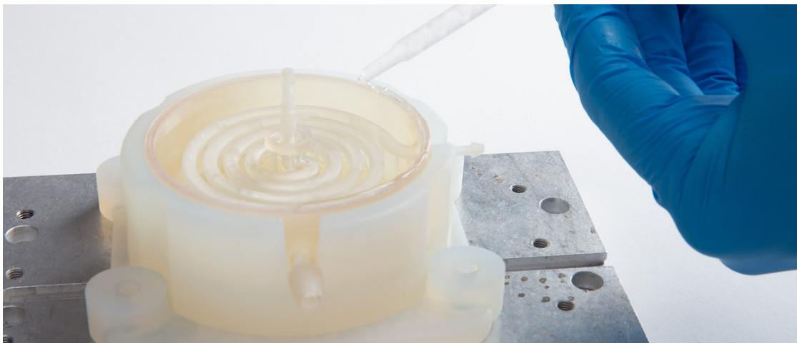
Adhésif appliqué sur une partie d'un gabarit de collage imprimé avec Durable Resin..
