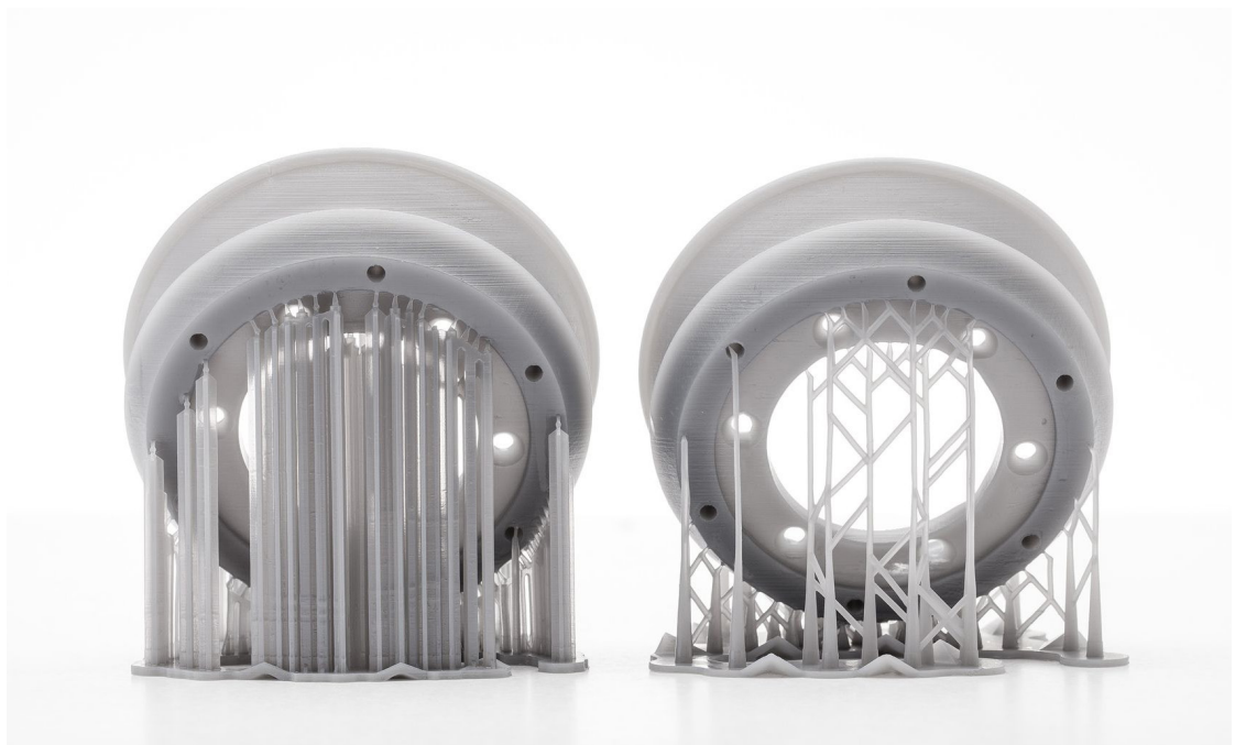
Les deux types de systèmes de SLA utilisent des structures de support pour fixer les pièces à la plateforme de fabrication.
