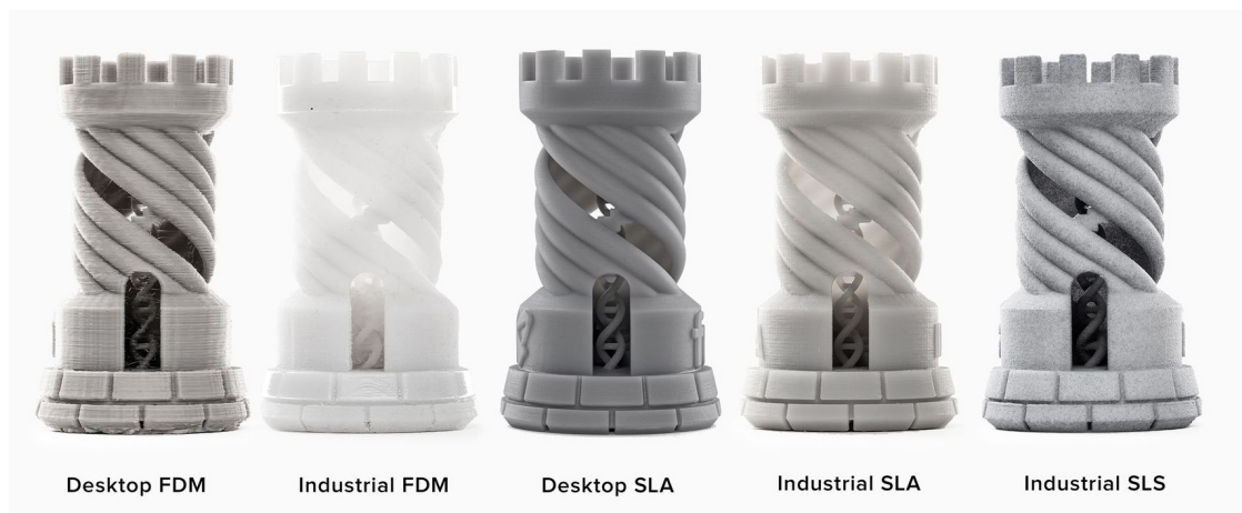
Tours imprimées à une hauteur de couche de 100 microns sur une machine FDM de bureau et industrielle, une imprimante SLA de bureau (Form 2), et des imprimantes 3D industrielles SLA et SLS.
