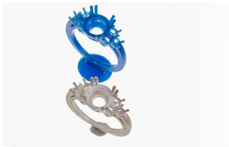
Fig. 6: Modèle numérique de bague, imprimée et moulée, avec pierre centrale de 8 mm et pierres latérales de 2,5 mm.
