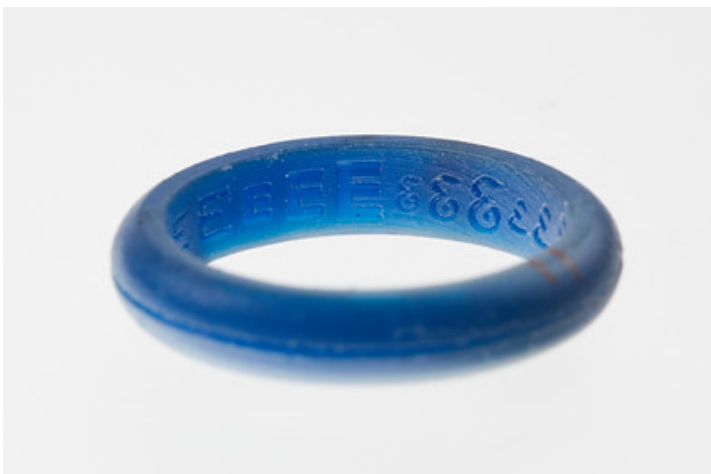
Fig. 11.3 : Impression de la bague avec une profondeur de gravure de 0,5 mm.
