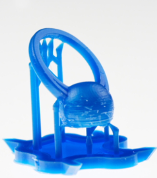
Fig. 14.1 : Erreur d'impression d'une bague avec tête sphérique avec l'orientation suggérée par PreForm.
