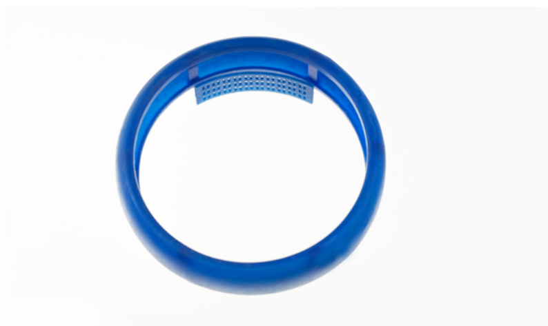
Fig. 5.3 : Modèle numérique et imprimé d'un bracelet creux avec surface intérieure décorative. Cet exemple montre l'une des six surfaces intérieures, gravée avec filigrane, qui empêcherait le moulage complet si le bracelet était imprimé d'une seule pièce.
