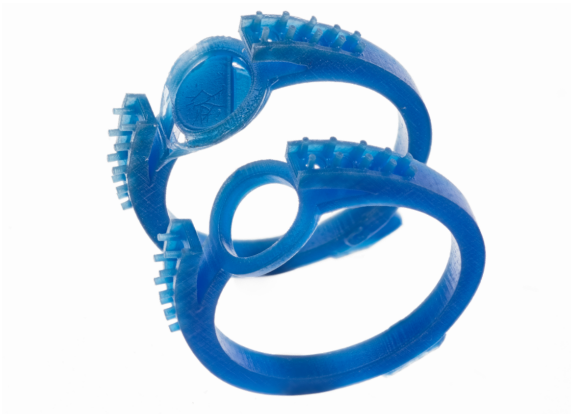
Fig. 13 : La pièce du haut est le résultat de l'impression d'un fichier utilisant des composants groupés, sans avoir cherché à former un « solide étanche ». La pièce du bas est le résultat des mêmes composants assemblés correctement pour que l'ensemble forme un « solide étanche ».
