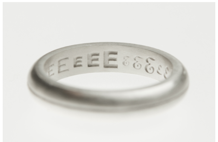
Fig. 11.4 : Moulage avec une profondeur de gravure de 0,5 mm. Notez que la plus petite lettre E a une meilleure définition et peut supporter la finition, mais sans certitude.
