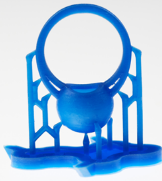
Fig. 14.2 : Bague avec tête sphérique et ouverture face en haut (ou face en bas pour la fabrication afin de ne pas se remplir de résine). La surface en bas de la sphère présente une légère déformation.
