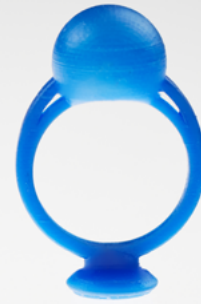
Fig. 14.3 : Bague avec tête sphérique et supports et base générés par CAO. L'orientation qui a donné le meilleur résultat est « incorrecte » en raison du risque de remplissage de la sphère par la résine.
