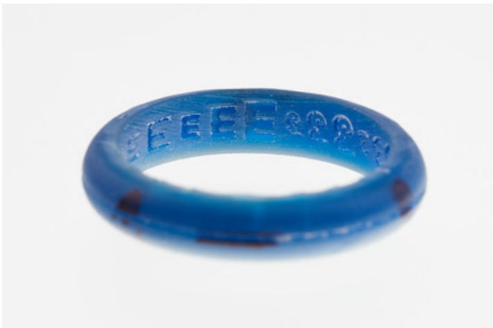
Fig. 11.1 : Impression de la bague avec une profondeur de gravure de 0,3 mm.
