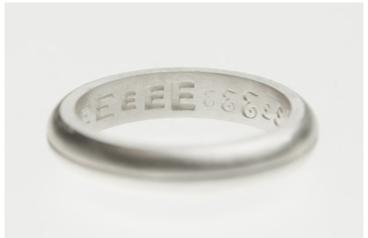
Fig. 11.2 : Moulage avec une profondeur de gravure de 0,3 mm. Notez que, bien que le plus petit script E soit visible, il peut perdre sa définition à la finition et au polissage.
