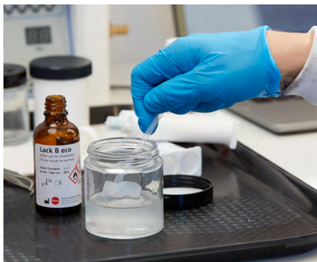
Fig. 21 : Revêtement du silicone avec de la laque Lack B eco finishing de Dreve.
