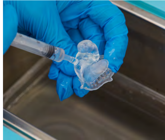
Fig. 14 : Injection d'alcool isopropylique dans la pièce imprimée pour retirer toute la résine non polymérisée.
