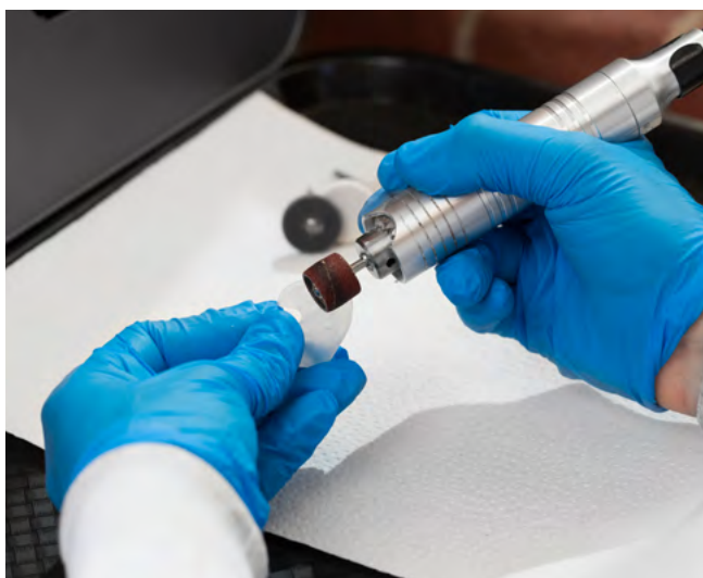
Fig. 20 : Finition de l'embout auriculaire en silicone avec du papier de verre de grain moyen sur une Dremel à manche flexible.
