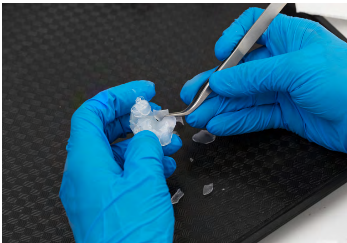
Fig. 19 : Casse et retrait de la coque de l'embout auriculaire.
