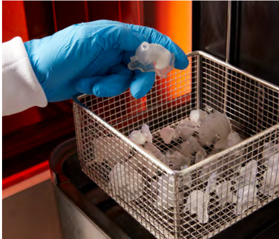
Fig. 13 : Nettoyer les impressions dans une Form Wash.
