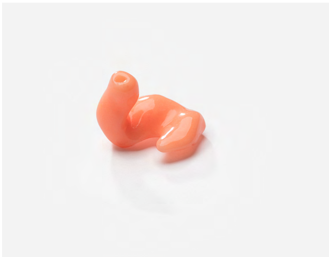
Fig. 1 : Un embout auriculaire en silicone moulé à partir d'une impression créée sur une imprimante SLA Formlabs.
