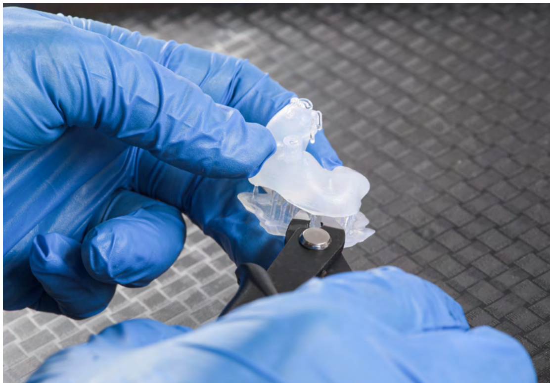
Fig. 18 : Retrait des supports avec une pince coupante.
