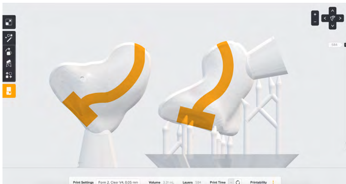
Fig. 11 : À gauche, une impression réussie d'une coque d'embout auriculaire, en utilisant le cône d'injection comme support et, à droite, la même coque d'embout auriculaire avec le cône d'injection à un emplacement différent, soutenu par les supports générés par PreForm.
