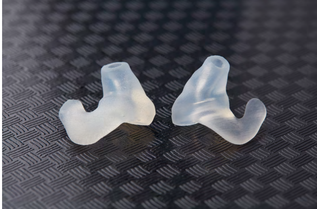
Fig. 17 : L'embout auriculaire de gauche a été post-polymérisé dans une Form Cure, sans pression. De toutes petites bulles dans le silicone donnent aux embouts auriculaires une apparence légèrement opaque. L'embout auriculaire de droite était sous pression pendant la polymérisation du silicone, il n'y a donc pas de bulles.
