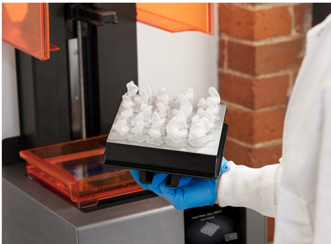
Fig. 12 : Cette plateforme de fabrication complète de coques d'embouts auriculaires est imprimée en environ 3,5 heures avec des couches de 100 microns d'épaisseur.
