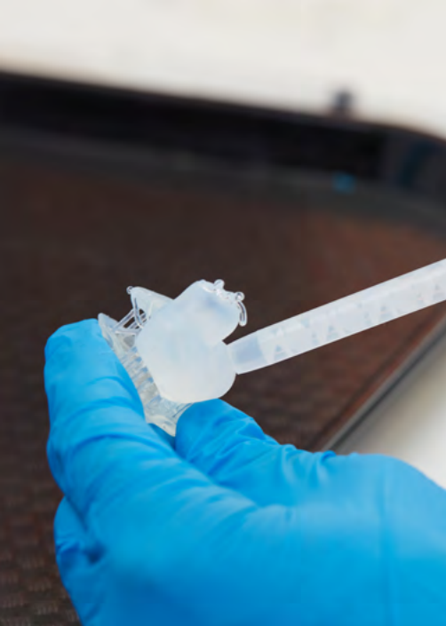
Fig. 16 : Injection du silicone BioPor® AB 40 Shore de Dreve dans la coque imprimée.
