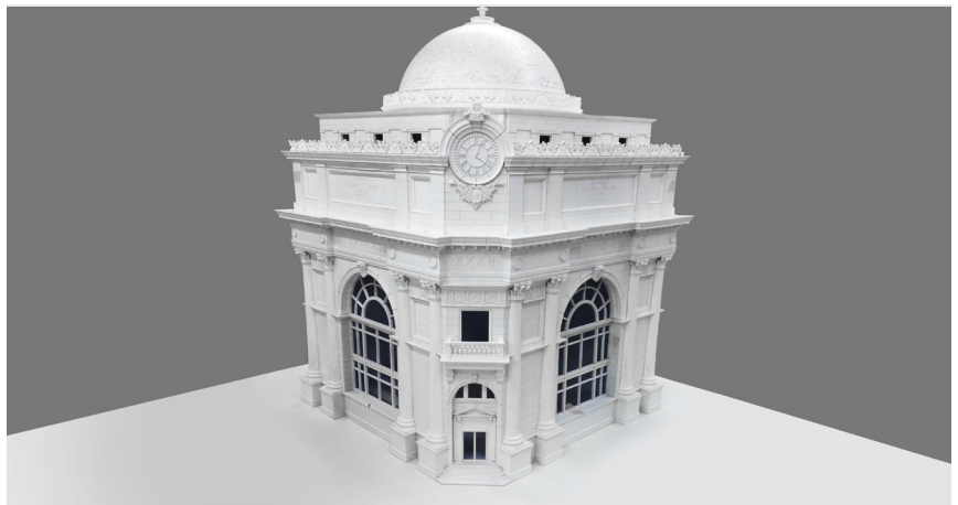
Pour ce modèle, des détails très délicats comme la corniche, l'horloge et les rambarde ont été imprimés sur la Form 2. Modèle réalisé par Myles Burke Architectural Models Inc.
