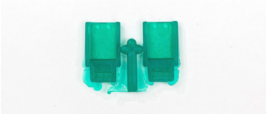
Bavure due au remplissage du moule en excès.
