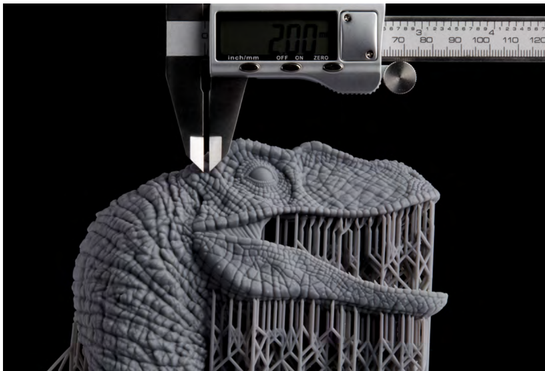
Modèle de vélociraptor créé par Daniel De Leon, imprimé en 3D avec Grey Resin sur l'imprimante Form 3 à une épaisseur de couche de 100 microns.
