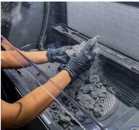
La Fuse Sift complète le processus de travail des imprimantes de la série Fuse. C'est un système efficace et sûr pour extraire les pièces et recycler la poudre. La Fuse Sift peut doser et mélanger automatiquement la poudre déjà utilisée et la poudre neuve, ce qui réduit le gaspillage et diminue la consommation de poudre.
