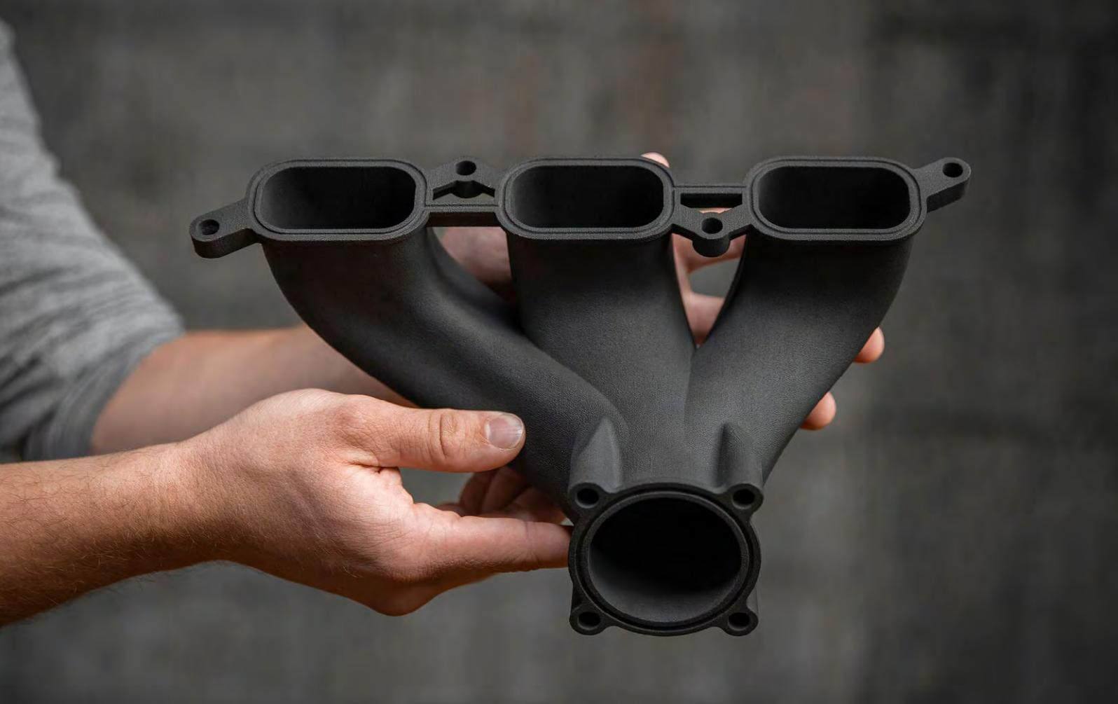
*Les pièces SLS présentent des surfaces légèrement rugueuses, mais les lignes de couche ne sont presque pas visibles. Il est recommandé d'effectuer un polissage par grenailage ou tonnelage des pièces SLS pour obtenir une bonne finition de surface. Cette pièce est un échantillon réalisé sur l'imprimante 3D SLS industrielle d'atelier Fuse 1+ 30W de Formlabs.*
