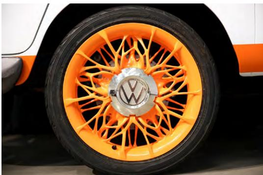
Les pièces imprimées par SLS peuvent être traitées par galvanoplastie pour obtenir un fini comparable à du métal.
