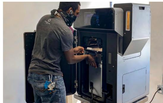
La chambre de fabrication des imprimantes de la série Fuse est amovible, ce qui permet de lancer une autre impression pendant que la précédente est en train de refroidir.
