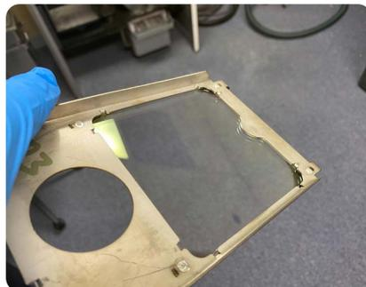
**Après le nettoyage :** Une cassette optique après nettoyage à l'Alconox, l'eau distillée et l'éthanol pour éliminer la contamination.
