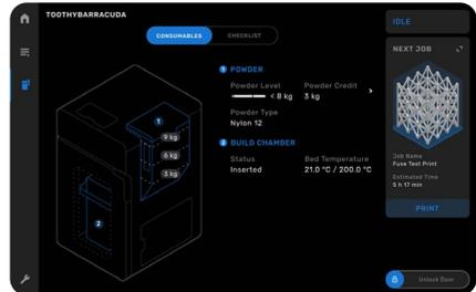
La Fuse 1 nécessite une maintenance périodique et informe les utilisateurs quand une procédure doit être effectuée. Chaque procédure est accompagnée d'instructions écrites et visuelles et organisée en une liste de contrôle où les tâches à accomplir sont mises en surbrillance rouge. Lorsqu'une tâche est terminée, la Fuse 1 continue à effectuer le suivi des intervalles de procédure en arrière-plan.
