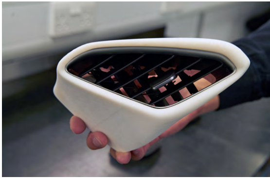
Un évent (à gauche) et un joint de porte (à droite) imprimés sur la Form 3L par Vital Auto.
