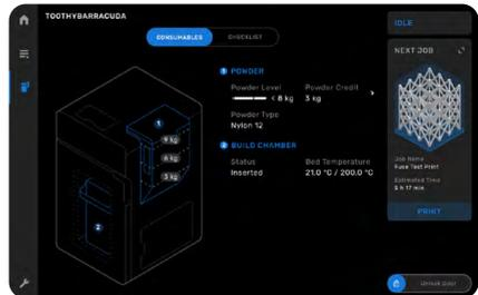
La Fuse 1+ nécessite une maintenance périodique et informe les utilisateurs quand une procédure doit être effectuée. Chaque procédure est accompagnée d'instructions écrites et visuelles, organisées en une liste de contrôle où les tâches à accomplir sont mises en surbrillance rouge. Lorsqu'une tâche est terminée, la Fuse 1+ continue d'effectuer le suivi de la fréquence des procédures en arrière-plan.
